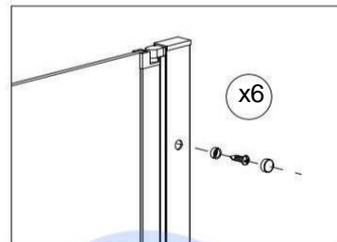
Befestigen Sie das Wandprofil für die Glastür (3) und das Profil
