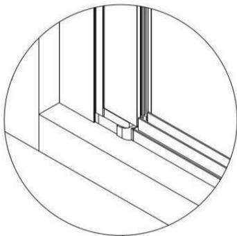
Installieren Sie den robusten Aluminiumstreifen (7) mit dem Glaszement auf dem Boden wässern oder unter der Dusche.
