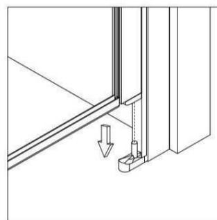
Schließen Sie die Glastür (10) an untere Drehzapfenbaugruppe (9).
