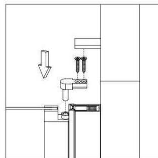
Drücken Sie die obere Drehbaugruppe (13) hinein die obere Nut des Glasprofils für die Glastür (4); dann stecke es fest und Profil mit Schrauben. Dann der Deckel die Schraube Standorte mit dekorativer Abdeckung für Wandprofil (14).
