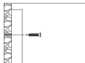
Befestigen Sie das Profil an der Wand die Glastür (3) an der Wand mit 4x30mm Schrauben (2).
