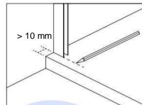
Halten Sie einen Abstand von 10 mm ein an den Rand der Dusche und zeichnen eine Strichmarkierung. Wandprofil für die Glastür (3) muss 10 mm vom Rand entfernt montiert Duschwannen.
