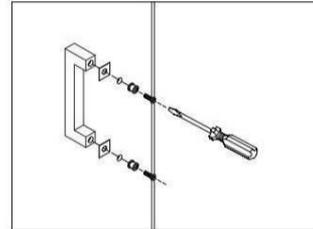
Montieren Sie den Griff (12) an der Außenseite der Tür aus Glas (10).
