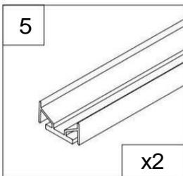
Dichtung für Profil von Glas & Glastür (2 Stück)
