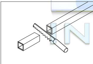
Schneiden Sie die Deckentragstange ab (6) auf die erforderliche Länge.
