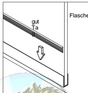
Montieren Sie die untere Profildichtung und die feste Tür (8) für das untere Profil (9).
