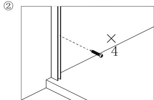
Verbinden Sie das Verbindungsprofil mit der Wand (1) mit Schrauben (4) an der Wand befestigen.
