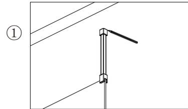
① Befestigung der Deckentragstange (6) senkrecht steht, dann markieren Sie die Position der Deckenklammer (5).
