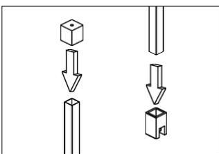
Verbinden Sie zunächst zur Prüfung die Deckenklemme (5) und die Glasklemme (7) mit der Deckentragstange (6).
