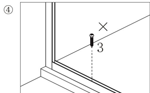
Verbinden Sie das untere Profil (9) mit den Schrauben (4) mit dem Boden oder der Duschwanne.
