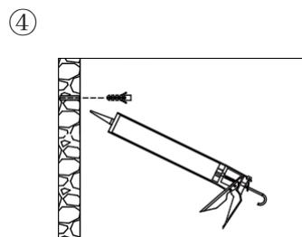
Setzen Sie die Kunststoffstopfen (3) in die Löcher ein. Spritzen Sie Silikon in die Löcher.
