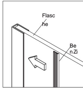
Wandprofileiste und feste Tür einbauen (2) für Wandanschlussprofil (1) an Wand.
