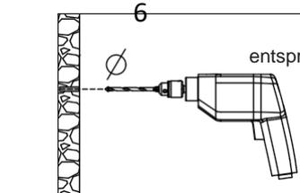
Bohren Sie Löcher (7- $\phi$ 6mm) in entsprechend der Kennzeichnung.
