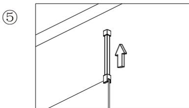
⑤ Montieren Sie die Deckenhaltestange (6) mit der Deckenklammer (5).
