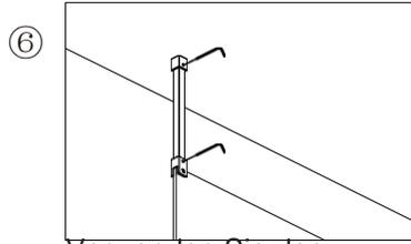
⑥ Verwenden Sie den Sechskantschlüssel, um die Deckenklemme (5) und die Glasklemme (7) zu verbinden.
