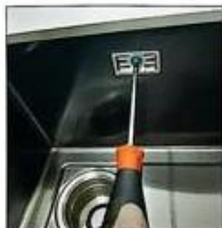
8: Utilizați o șurubelniță pentru a fixa șuruburile pentru a consolida scurgerea
